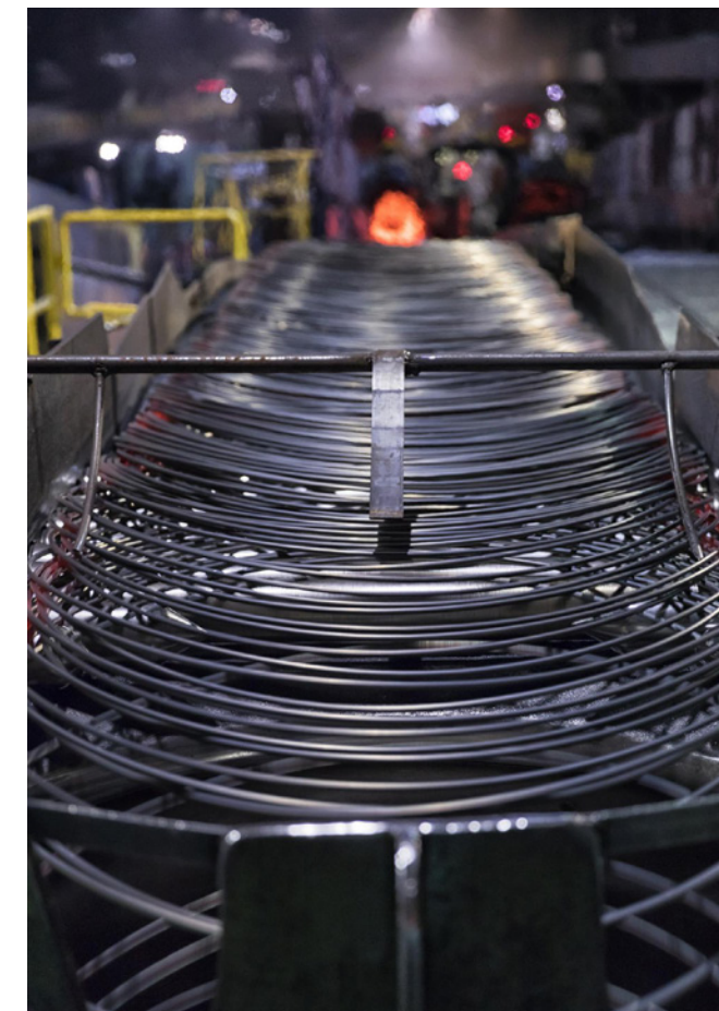
Trimmschrott minimieren, CO 2 einsparen: Eine KI unterstützt bei der Walzdrahtherstellung.
